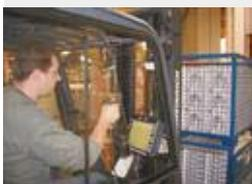
Jeder Gabelstapler bei Mahle ist mit einem leistungsfähigen Industrie-PC sowie mit einem Handscanner ausgestattet
